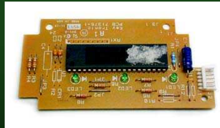
Billentyűzet vezérlő áramkör
