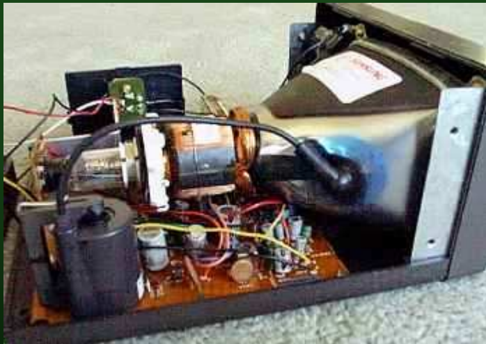
A vezérlő tekercsek elektromágneses mezőt keltenek
