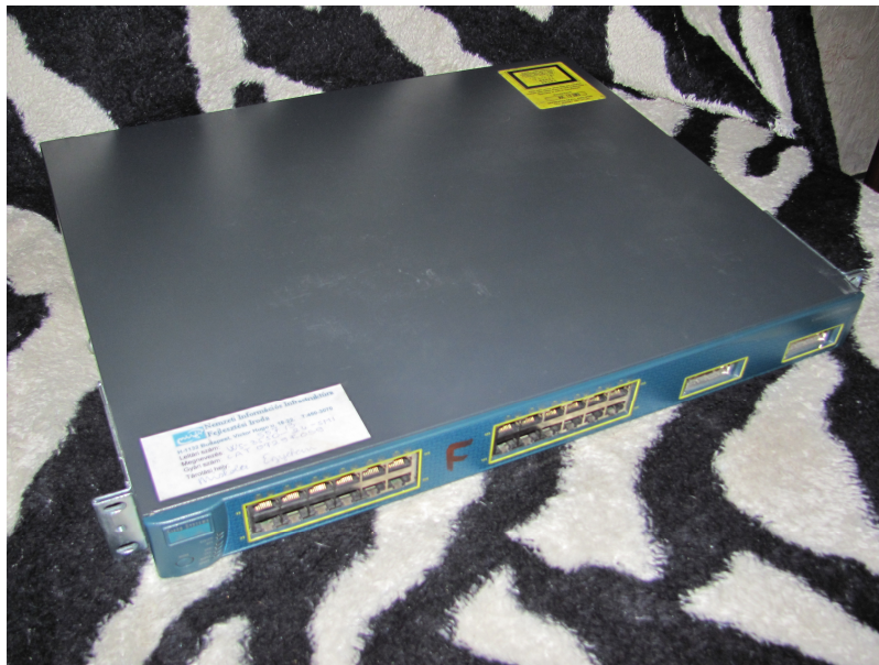
5. ábra A Cisco Catalyst 3550 típusú switch
